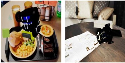
그림 1. DOPE 훈련 이미지의 예시. 왼쪽은 임의의 배경과 장애물에 임의의 자세를 갖는 로봇의 이미지이고, 오른쪽은 Falling Things[7] dataset을 참조해 현실적인 물리를 적용하여 낙하하는 로봇을 포착한 photorealistic 이미지이다
